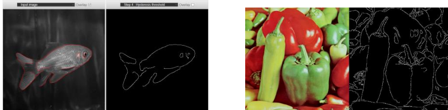
Figura 10 Rezultatul algoritmului Canny asupra unei poze cu un pește și o plantă[3]
